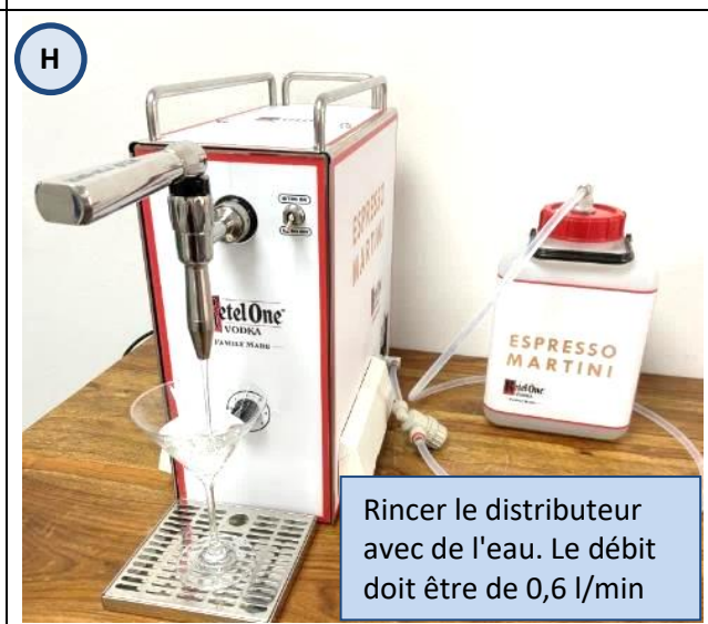
Tournez le cadran de température sur 7 pour les distributeurs de bière froide standard. Sur les distributeurs de cocktails avec une configuration plus froide, réglez-le sur 4.
